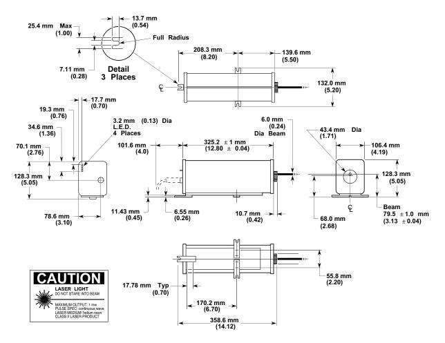
Figure 5-9. Agilent 5517D Laser Head dimensions
